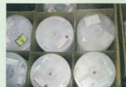
リターナブル（回収・再利用）される電子部品保護用のトレー、リール
